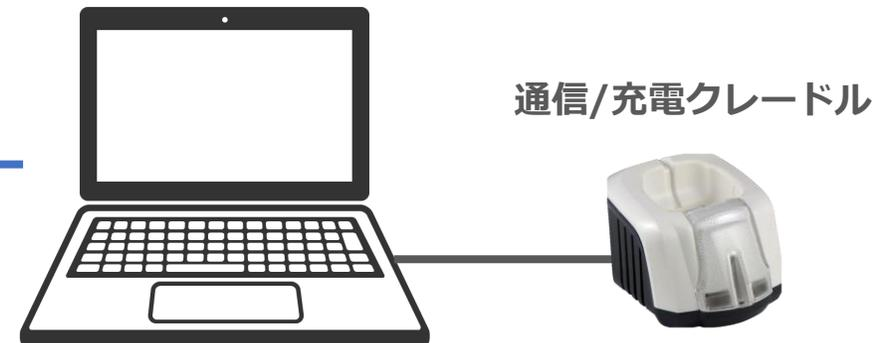
\* クレードルのBluetoothアドレスが確認できない場合、ペアリング切断状態のクレードルをホストにUSBケーブルで接続し、Auto Detectionを選択するとBluetooth Addressに自動入力されます。
